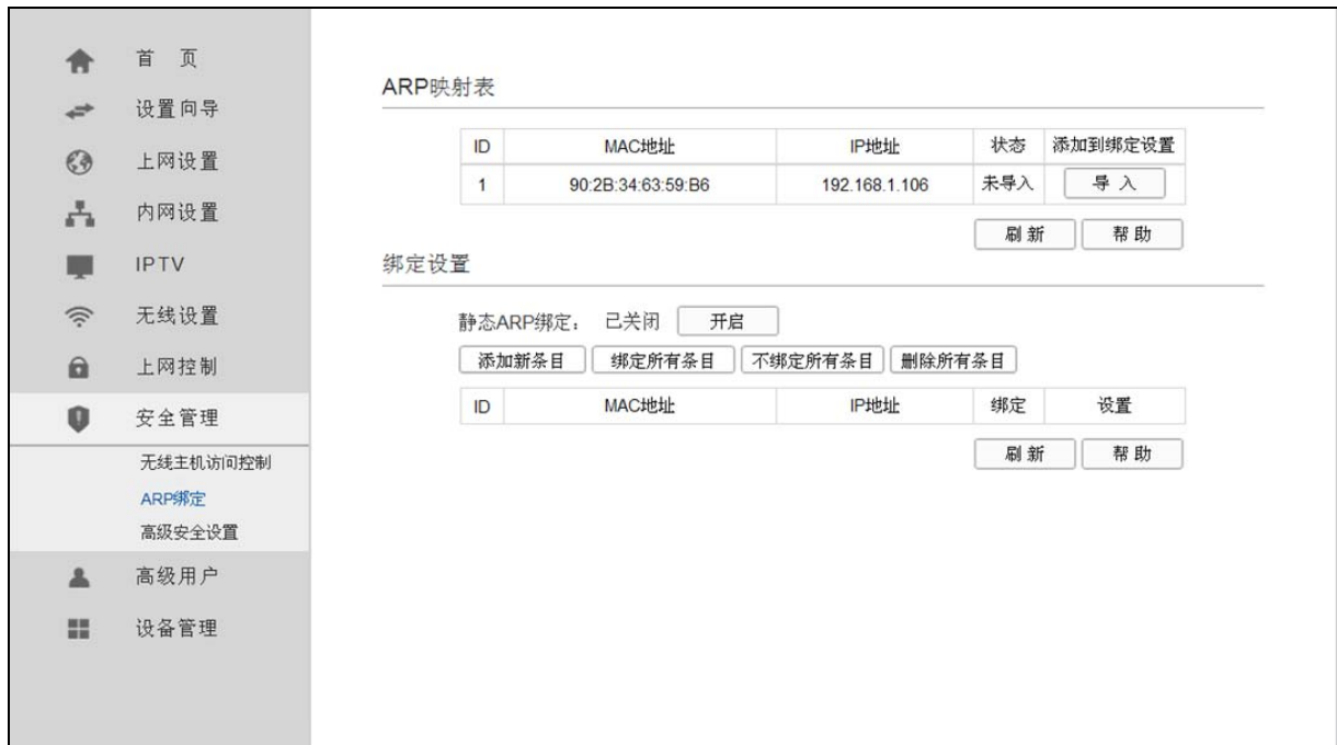
图 66 静态 ARP 绑定设置
