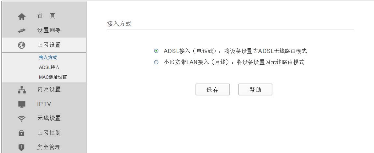
图 25 ADSL 接入方式
