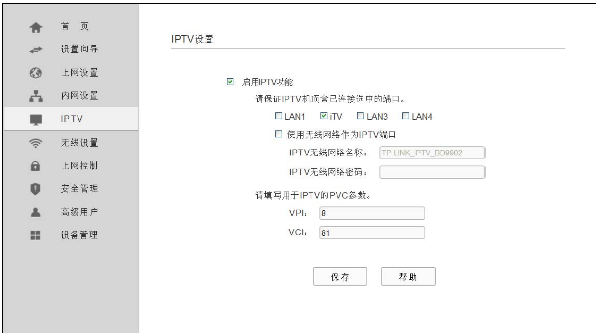
图 42 IPTV 设置—ADSL 无线路由模式
