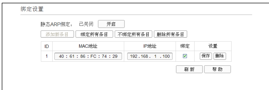
图 67 添加静态 ARP 绑定条目
