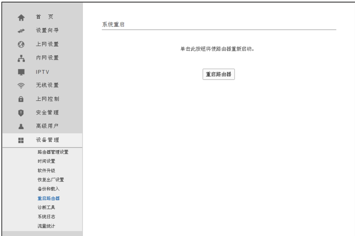
图 83 重启 ADSL 无线路由一体机
