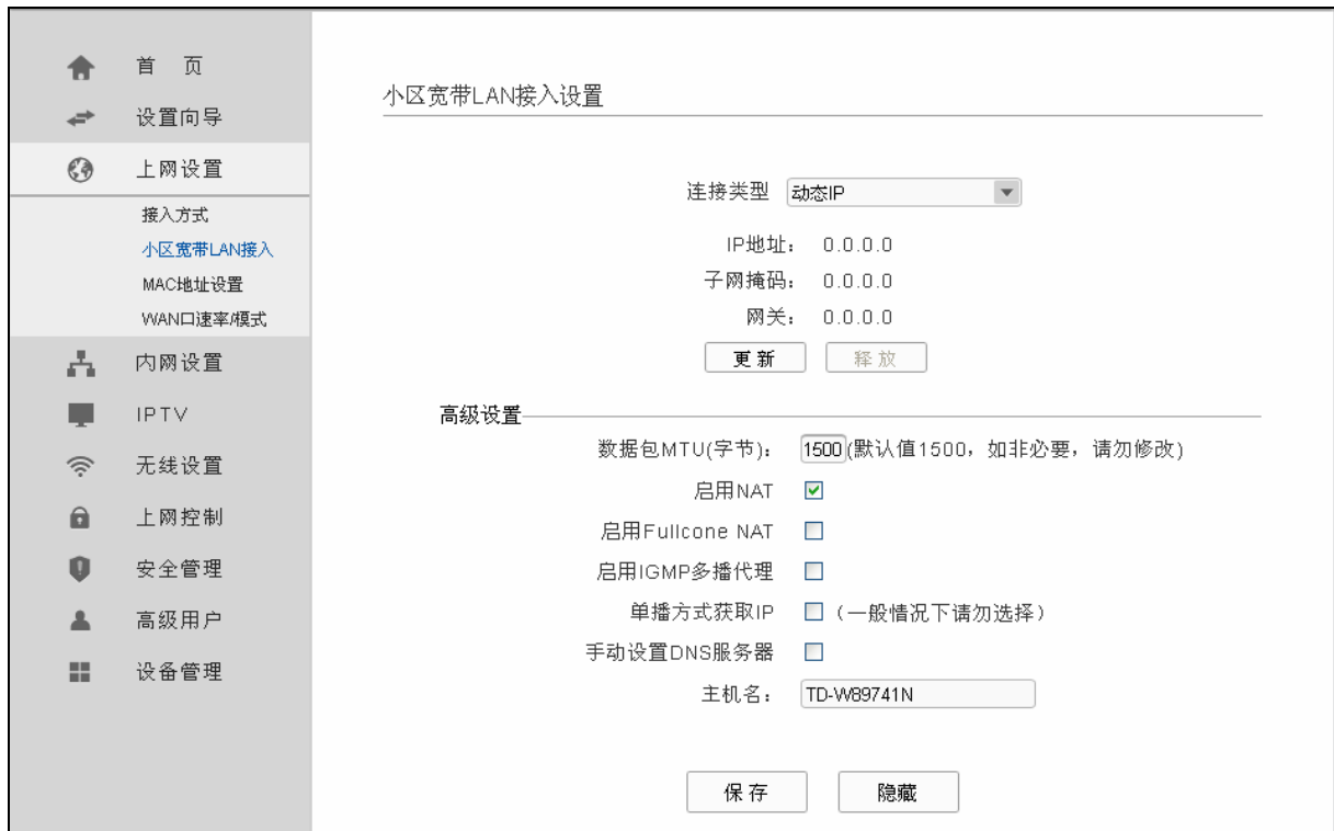
图 32 小区宽带 LAN 接入-动态 IP
