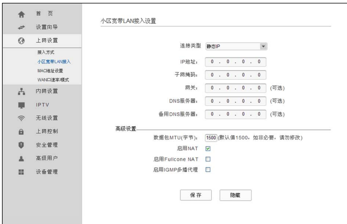
图 31 小区宽带 LAN 接入-静态 IP
